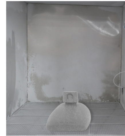
Ensayo Arteike: nube en movimiento continuo de 2 kg/m 3 de polvo de diámetro inferior a 75µm.
