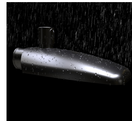
Ensayo Arteike: proyección de agua desde todos los ángulos a un promedio de 100 l/min con una presión de 100 kN/m 2 .
