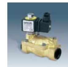
81870-69 Electroválvula de agua Normalmente abierta para control de suministro de agua - Rearme automático. Conexión R 3/4" G - Alimentación: 127V-60 Hz. Grado de protección: IP 65 - Para detector de agua de empotrar (Art. 75860-30)
