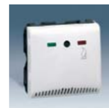
75861-30 Detector de gas empotrable Detector de gas, permite detectar la presencia de gases tóxicos y explosivos, tales como: butano, propano, metano, gas ciudad, gas natural y otros. En caso de alarma dispone de led color rojo y señal sonora, pudiendo comandar una electroválvula (Art. 81871-39) para el cierre automático del suministro de gas. Dispone de led de servicio (verde), led bicolor alarma/avería (rojo y ámbar) y pulsador de test. CONECTAR UN SÓLO DETECTOR TÉCNICO A CADA FUENTE DE ALIMENTACIÓN. (Se instala con las placas de la Serie Simón 27)
