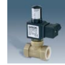
81871-39 Electroválvula de gas Normalmente abierta para control de suministro de gas - Rearme manual - Conexión R 3/4" G Alimentación: 127 V-60 Hz - Grado de protección: IP 54 - Para detector de gas de empotrar (Art. 75861-30)
