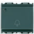
16643 Para llamada de emergencia, 2 salidas de relé NO 5 A 250 V~, alim. 12 V~ 50/60 Hz / 12-24 Vdc (SELV) - 2 módulos. Profundidad: 35,5 mm
