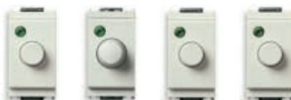
16560.B 100-500 W 230 V~ 50/60 Hz, potenciómetro. Profundidad: 39,5 mm 16563.B 100-500 W 230 V~ 50/60 Hz, push-push y potenciómetro. Profundidad: 39,5 mm *16556.B 60-900 W/ 60-300 VA 230 V~ 50/60 Hz, potenciómetro. Profundidad: 39,5 mm 16557.B 30-500 W/ 30-300 VA 120 V~ 50/60 Hz, potenciómetro. Profundidad: 39,5 mm
