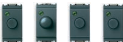
16560 100-500 W 230 V~ 50/60 Hz, potenciómetro. Profundidad: 39,5 mm 16563 100-500 W 230 V~ 50/60 Hz, push-push y potenciómetro. Profundidad: 39,5 mm *16556 60-900 W/ 60-300 VA 230 V~ 50/60 Hz, potenciómetro. Profundidad: 39,5 mm 16557 30-500 W/ 30-300 VA 120 V~ 50/60 Hz, potenciómetro. Profundidad: 39,5 mm
