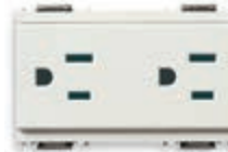
16243.B Dos SICURY 15 A, americano y saudita - 3 módulos. Profundidad: 26,5 mm
