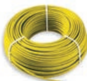
Δ 01840.Y Cable para sistema anti-intrusión Bus, sin halógenos 2x0,50 mm 2 , tensión nominal tierra 400 V adecuado para cables de categoría I, amarillo - 100 m
