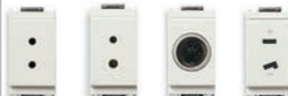
16300.B 2P 6 A 24 V (SELV) para clavija 01620. Profundidad: 26 mm 16301.B 2P 6 A 24 V (SELV) para clavija 01616 y 01617. Profundidad: 26 mm 16332.B Toma de conector 5P DIN 41524. Profundidad: 10,5 mm 16345.B 2P 6 A 24 V (SELV), polarizada. Profundidad: 26 mm
