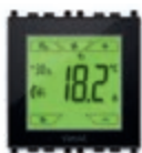
■ 02952 Termostato táctil para control de temperatura ambiente de 2 zonas independientes, estándar KNX, salida de relé NO 4 A 24 V~ + 1 entrada con sensor de temperatura + 1 entrada digital programable - 2 módulos. Montaje con soporte específico 16723. Profundidad: 38,5 mm
