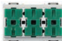
16987.B 3 pulsadores basculantes + actuador persiana 8 A 120-230 V~ - 3 módulos. Profundidad: 35 mm
