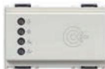
■ 16927.B Lector tarjeta transponder para instalación fuera de la habitación, estándar KNX, 2 salidas relé NO 4 A 24 V~, 2 entradas, 12-24 V~ 50/60 Hz y 12-24 Vdc (SELV) - 3 módulos. Profundidad: 36,5 mm
