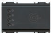
■ 16927 Lector tarjeta transponder para instalación fuera de la habitación, estándar KNX, 2 salidas relé NO 4 A 24 V~, 2 entradas, 12-24 V~ 50/60 Hz y 12-24 Vdc (SELV) - 3 módulos. Profundidad: 36,5 mm
