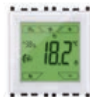
■ 02952.B Termostato táctil para control de temperatura ambiente de 2 zonas independientes, estándar KNX, salida de relé NO 4 A 24 V~ + 1 entrada con sensor de temperatura + 1 entrada digital programable - 2 módulos. Montaje con soporte específico 16723.B. Profundidad: 38,5 mm
